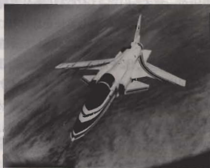
図A-1 不安定だが機動性が高い前進翼の戦闘機X-29A 米Grumman Aerospace社製。
