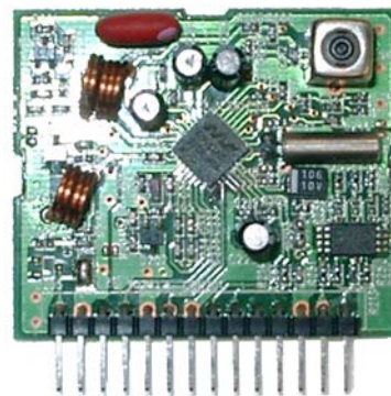
図 3 CMOS アナログ回路技術を用いた LSI を用いた FM/AM チューナーボード
