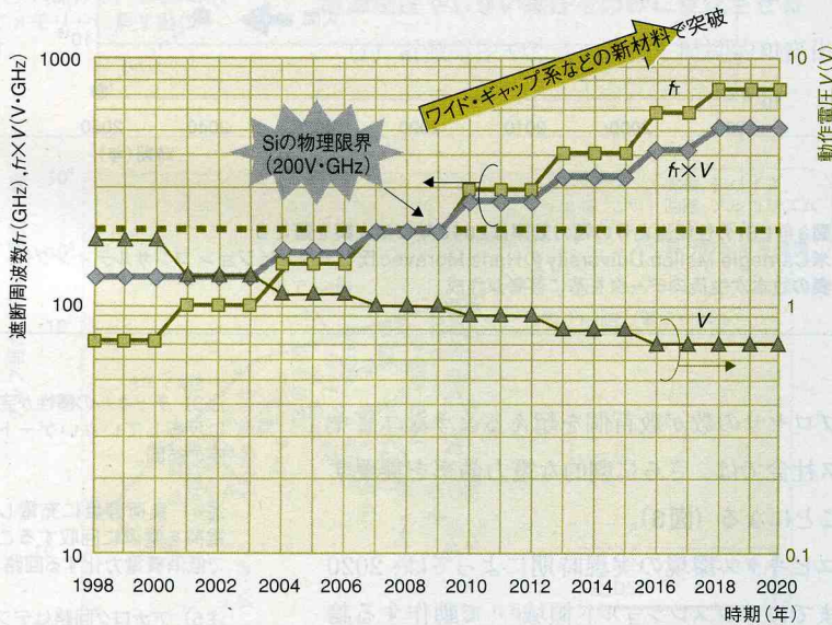
図1 ● 動作電圧の向上には新材料が必要に 2010年以降に動作周波数と動作電圧を同時に向上させるにはバンド・ギャップの大きい新材料の導入が必要になる。著者による予測データ。
