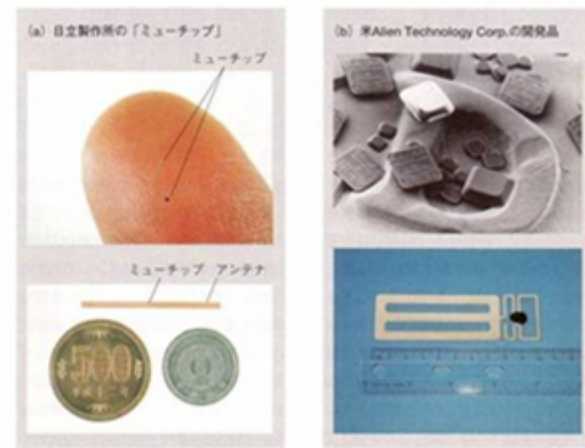
図1 「粉末」のような無線タグ用チップが登場 日立製作所の「ミューチップ」の外形寸法はわずか0.4mmX0.4mmX0.06mmである。(a)、これにアンテナを併せて使う。通信に用いる周波数は2.45GHzである。Alien Technology Corp.が開発したチップは1辺が0.15mm〜0.2mmとさらに小さい。(b)、30mmX100mm程度のアンテナを併付けることで、リーダーと5mほど離れた場所でも使えるという。用いる周波数は915MHz (米国向け)、868MHz (欧州向け)、2.45GHz (日本向け)の3種類。
